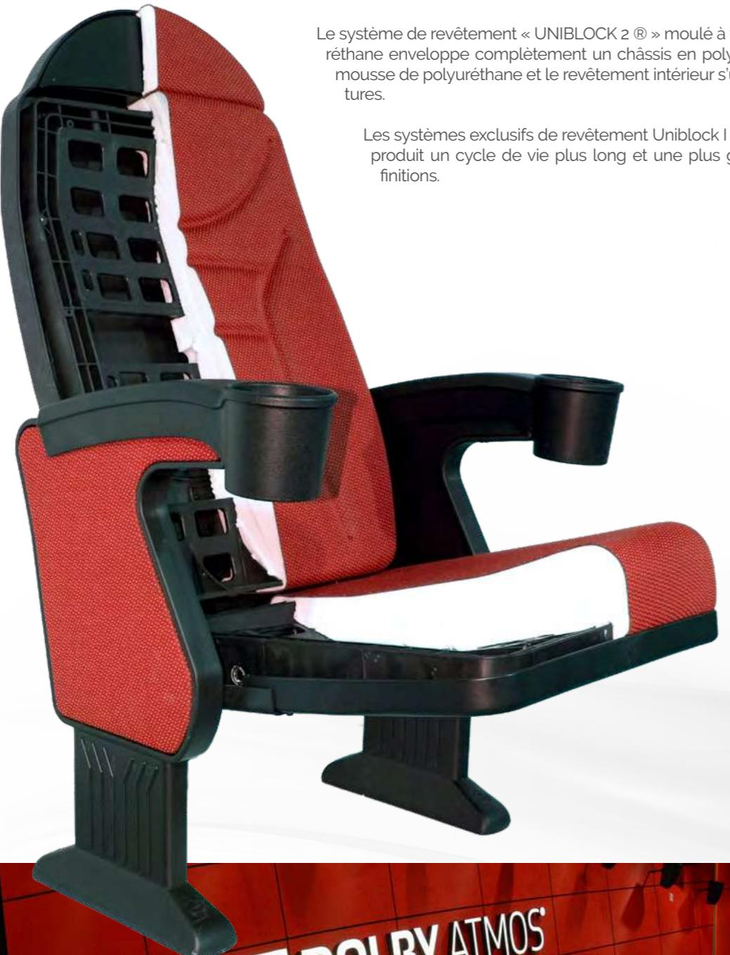
Le système de revêtement « UNIBLOCK 2 ® » moulé à froid en mousse de polyuréthane enveloppe complètement un châssis en polypropylène injecté dans la mousse de polyuréthane et le revêtement intérieur s'unit à la mousse sans coutures.
