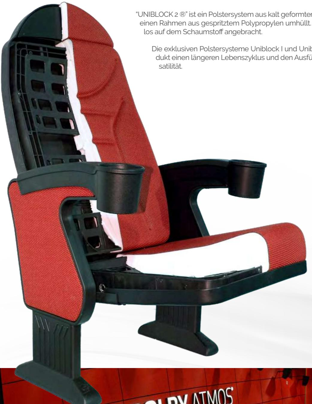
"UNIBLOCK 2 ®" ist ein Polstersystem aus kalt geformtem Polyurethanschaum, der einen Rahmen aus gespritztem Polypropylen umhüllt. Der Polsterstoff wird nahtlos auf dem Schaumstoff angebracht.
